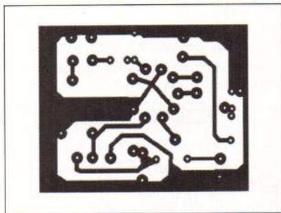
Fig. 4 - Circuito stampato ricevitore (lato rame).
