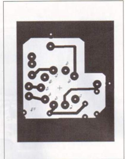
Fig. 6 - Circuito stampato amplificatore EL84 (lato rame).
