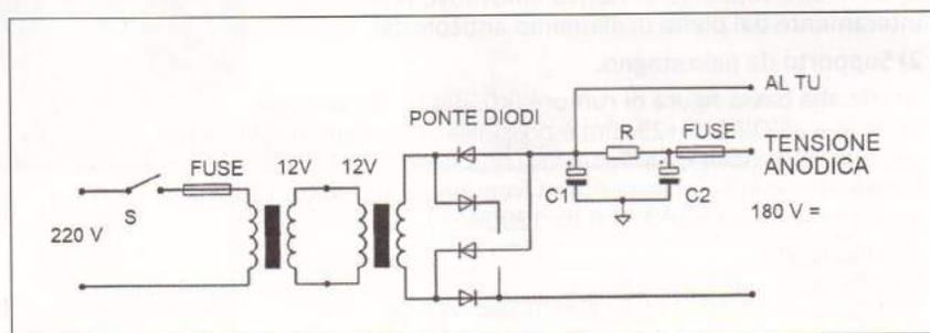
Fig. 2 - Circuito elettrico alimentatore anodico
