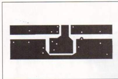
Fig. 5 - Alimentatore per filamenti (circuit stampato).
