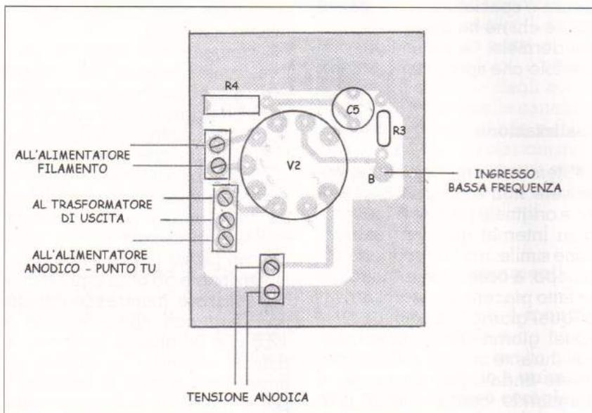
Fig. 9 - Amplificatore di bassa frequenza (layout componenti).
